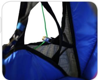
La ligne d'accélérateur doit alors ressortir à travers l'oeilletton à l'avant - Assurez-vous que la ligne glisse proprement entre la poulie et l'anneau et vérifiez particulièrement qu'il n'y a pas d'emmêlage avec l'élastique.
