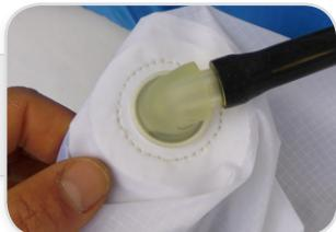
Fermer l'autre côté du sac en le roulant à la main et continuer de façon à comprimer l'air pour qu'il soit chassé vers la protection.
