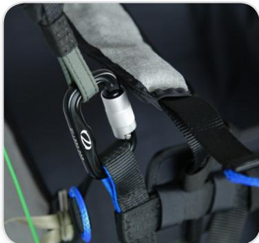
Les élévateurs de votre aile doivent être connectés à votre sellette sur les points d'ancrage principaux avec les élévateurs A tournés vers l'extérieur.
