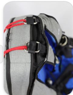
La poignée du secours doit être connectée à une boucle extérieure du pod par une tête d'alouette. Nous recommandons de l'attacher à la boucle située sur le côté du pod si c'est possible plutôt que sur la boucle centrale.
