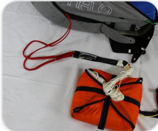
Les sangles de la sellette doivent être attachées à celle du secours par une connexion adaptée (non fournie).
