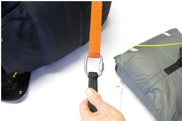
Relier le parachute de secours à la sangle en V de la sellette avec un Maillon Rapide C6 ou C7. Il devra être verrouillé avec une clé et un joint torrique de sorte qu'une ouverture fortuite soit impossible.
