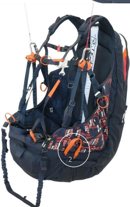
**!** Si un seul parachute doit être installé dans le container #1, remplissez le container #2 à l'aide de l'insert. Dans ce cas, fermez le container #2 selon les instructions du paragraphe 6 du manuel "Installation du parachute de secours #2".
