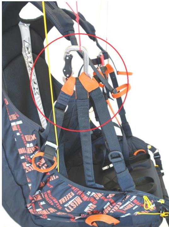
**I** les sangles d'inclinaison latérale, centrale et d'assise sont clipsées directement dans le mousqueton comme indiqué sur la photo de gauche, indépendamment du type de mousqueton utilisé.
