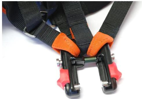
! Après avoir clippé l'élévateur du parapente avec le mousqueton largeur, n'oubliez pas de verrouiller les boutons afin d'éviter tout largage non intentionnel.
