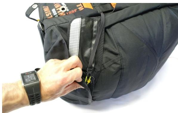
Fermez le cache-épingle à l'aide de Velcro et placez les sangles de la poignée de secours dans le „tunnel” du volet #2
