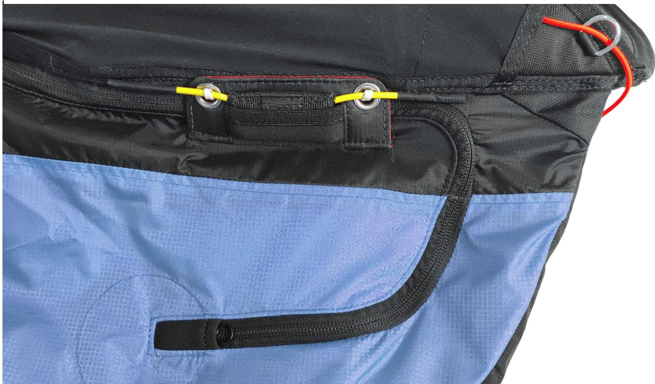
Lorsqu'un parachute de secours est monté dans l'airbag, le jonc supplémentaire peut être logé dans la face intérieure de l'ouverture du conteneur.
