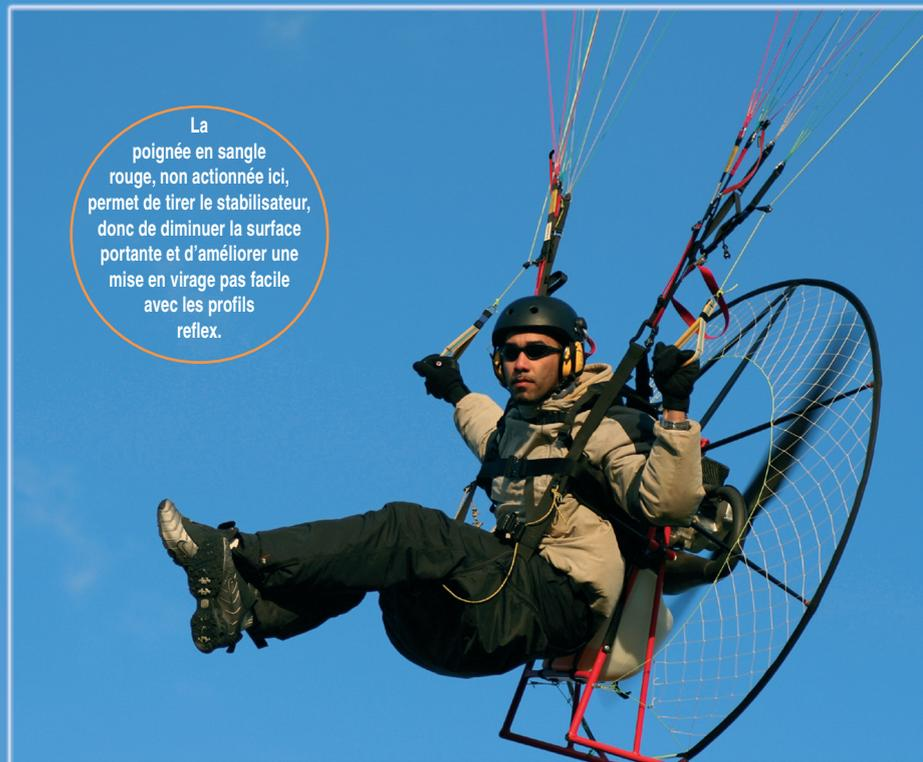
La poignée en sangle rouge, non actionnée ici, permet de tirer le stabilisateur, donc de diminuer la surface portante et d'améliorer une mise en virage pas facile avec les profils reflex.
