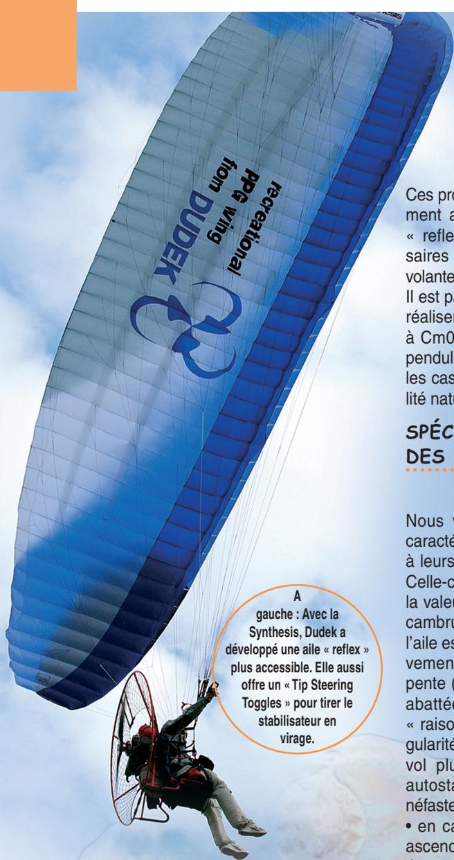
A gauche : Avec la Synthesis, Dudek a développé une aile « reflex » plus accessible. Elle aussi offre un « Tip Steering Toggles » pour tirer le stabilisateur en virage.
