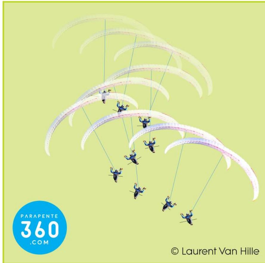
Un peu comme sur une balançoire, il y a une accélération à gauche, puis lorsque le pilote arrive au plus haut à gauche, il inverse tout pour accélérer vers la droite... en roulis bien entendu ! C'est donc au moment où le pilote est le plus haut, que l'aile ne se penche plus, que le pilote doit inverser.
