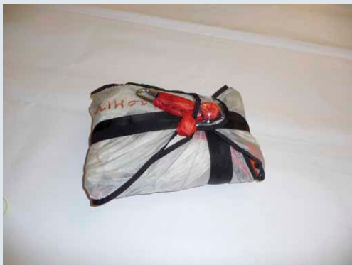
Figure 18: ... Procéder à la fermeture finale du pod au moyen d'une boucle du suspentage terminal, enveloppée de sa protection, passée dans l'élastique noir. Cette boucle sera positionnée dans le logement transparent prévu
