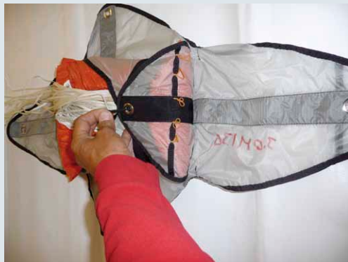
Figure 11: ... le passage de l'élastique continue à l'intérieur de l'œillet du rabat intérieur du haut ...
