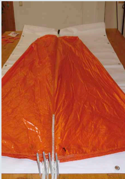
Figure 3: suspentes dégagées et réparties de part et d'autre de l'Apex central
