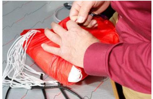
Container schließen und sicherstellen, dass alle Hilfsleinen entfernt wurden
