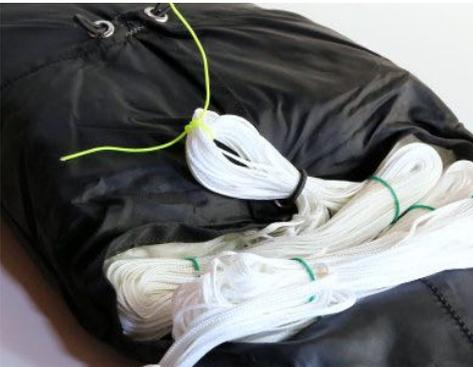
Zentrale Fangleinenschlaufe mit Packschnur zusammenbinden
