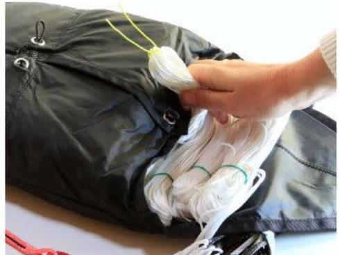
Fangleinenschlaufe behutsam aus dem zentralen Verschlussgummi lösen
