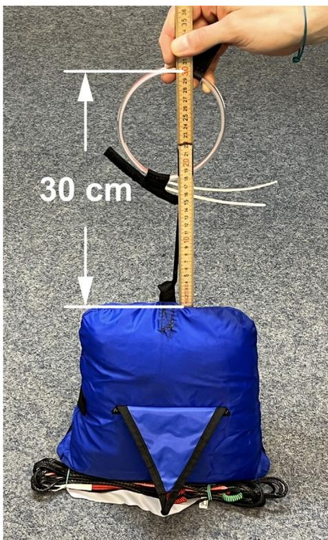
der Fangleinen zu verhindern, darf die Länge der Verbindung vom Auslösegriff zum Innencontainer maximal 37 cm betragen.
