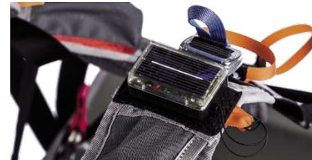
Un morceau de Velcro sur la sangle d'épaule permet la fixation facile d'un mini-vario ou un micro.
