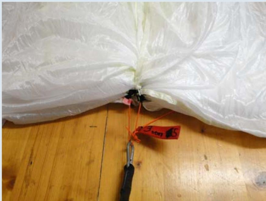
**1) Les pattes de pliage sur la cheminée centrale sont regroupées avec une cordelette de pliage de couleur. La cordelette est attachée à un point fixe de la table de pliage. Le numéro des panneaux est indiqué sur les pattes de pliage pour éviter toute omission.**
