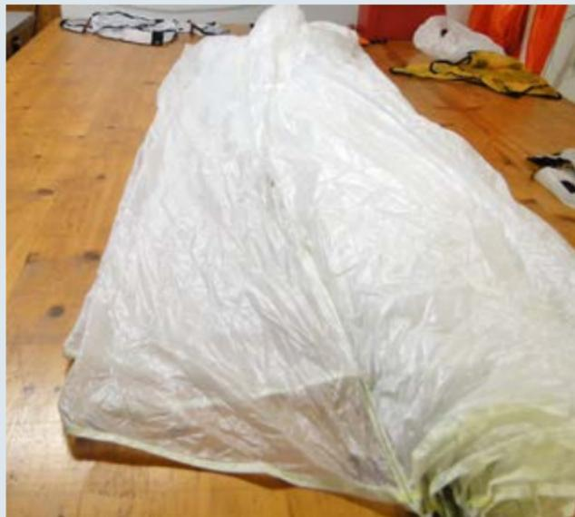
**4) Retourner la partie supérieure tout en veillant à ce que le panneau inférieur reste symétrique. Poser tous les panneaux les uns sur les autres de l'autre côté, à l'exception du panneau inférieur. Ramener les panneaux un à un sur le panneau inférieur, bien étalés, jusqu'à ce que tous les panneaux soient posés correctement du même côté.**
