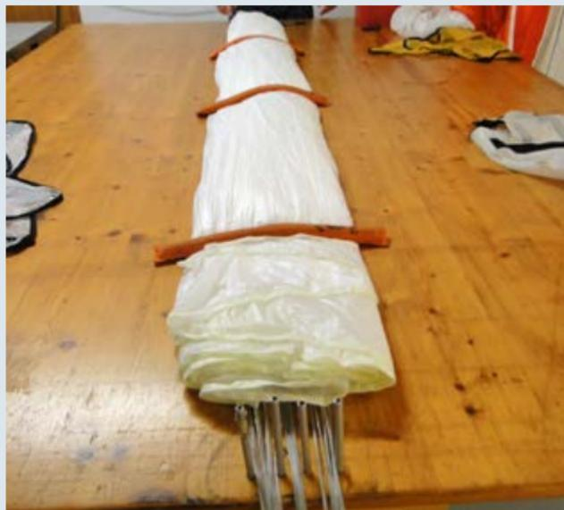
**7) Plier le parachute en formant un demi-S sur le dessus avec la partie gauche, et faire la même opération avec la partie droite, en-dessous, pour terminer.**
