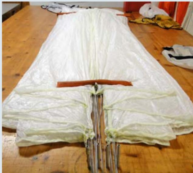
**Le parachute doit alors être disposé bien à plat sur la table de pliage avec l'ensemble des panneaux correctement étalés.**
