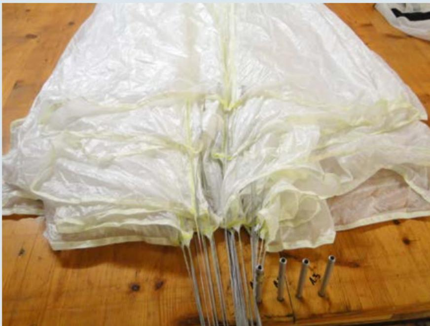
**2) Etendre le secours sur la table de pliage et répartir équitablement les panneaux de chaque côté. Le panneau numéro 1 doit être positionné au-dessus des deux côtés.**
