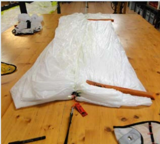
**5) Lorsque tous les panneaux sont pliés correctement, les maintenir avec des poids et répéter l'opération de l'autre côté.**
