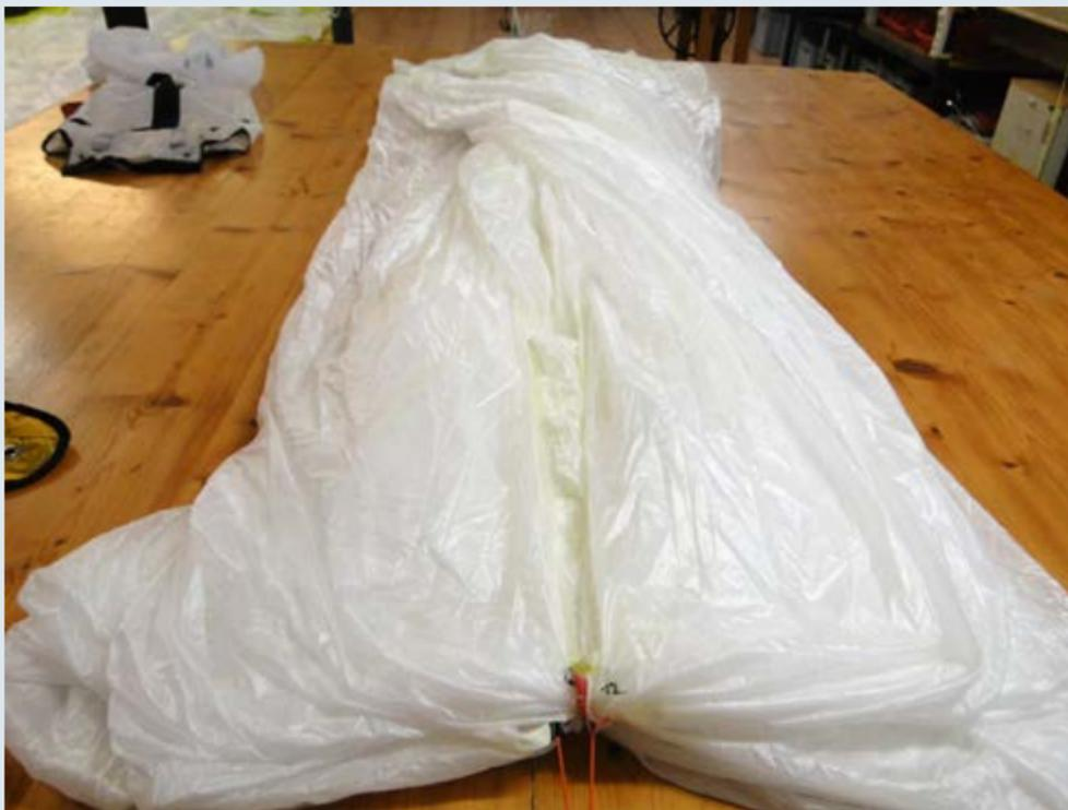
**3) Disposer les panneaux soigneusement. Le panneau du dessous doit être posé symétriquement au niveau des pattes d'attaches. Pour cela, tourner le parachute à cet endroit de telle sorte que le panneau du dessous se retrouve sur le dessus. Respecter la symétrie des deux côtés.**
