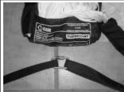
**Abbildung 22: Verbindung mit Schäkel**
