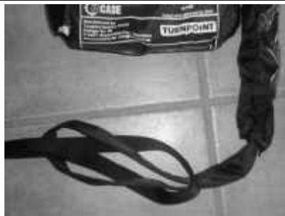
**Abbildung 23: Verbindung durch Einschlaufen**
