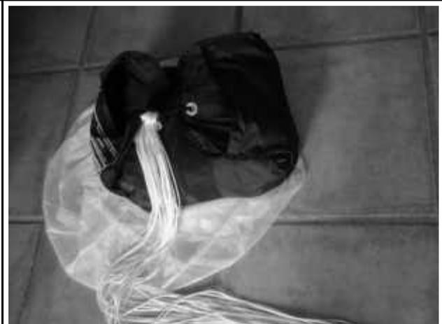
**Abb. 17: Fixierung durch Fangleinschlinge**
