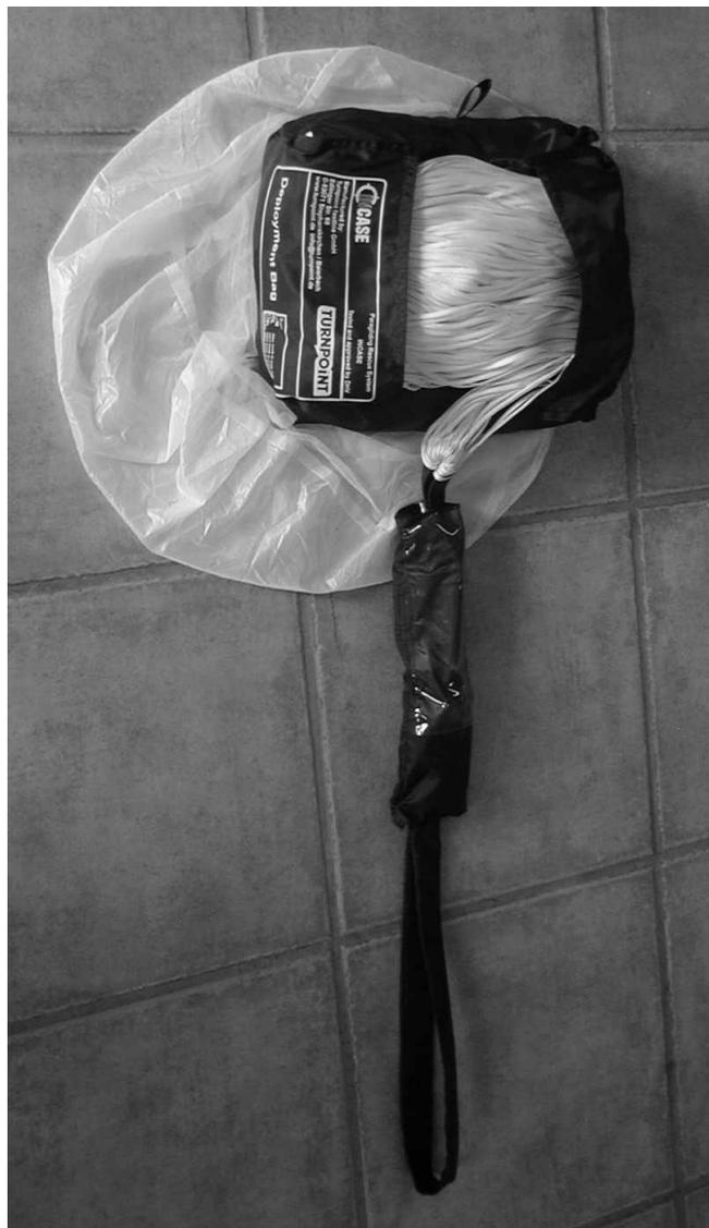
**Abbildung 21: Fertig gepacktes Rettungsgerät**
