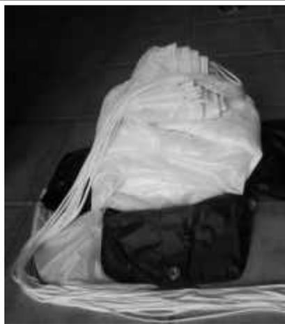
**Abb. 12: Einlegen der Kappe in S-Schlägen (fertig)**
