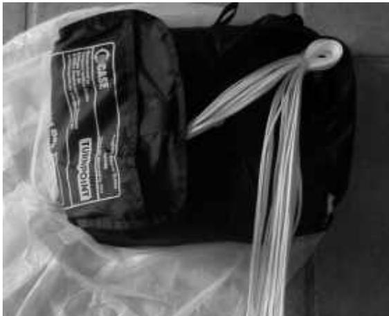
**Abbildung 19: Erste Fangleinenschlaufe**
