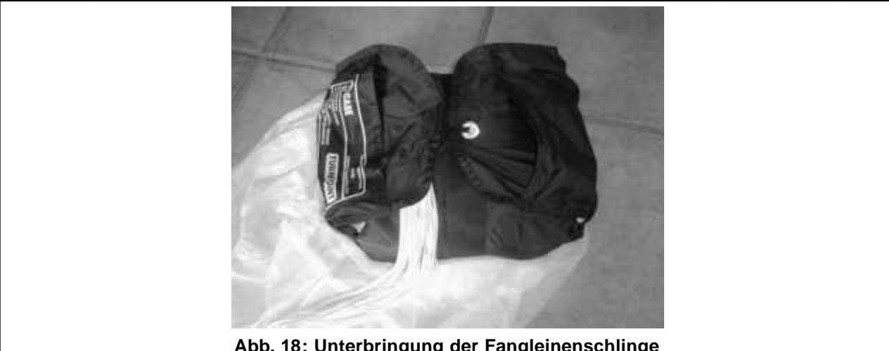
**Abb. 18: Unterbringung der Fangleinschlinge**
