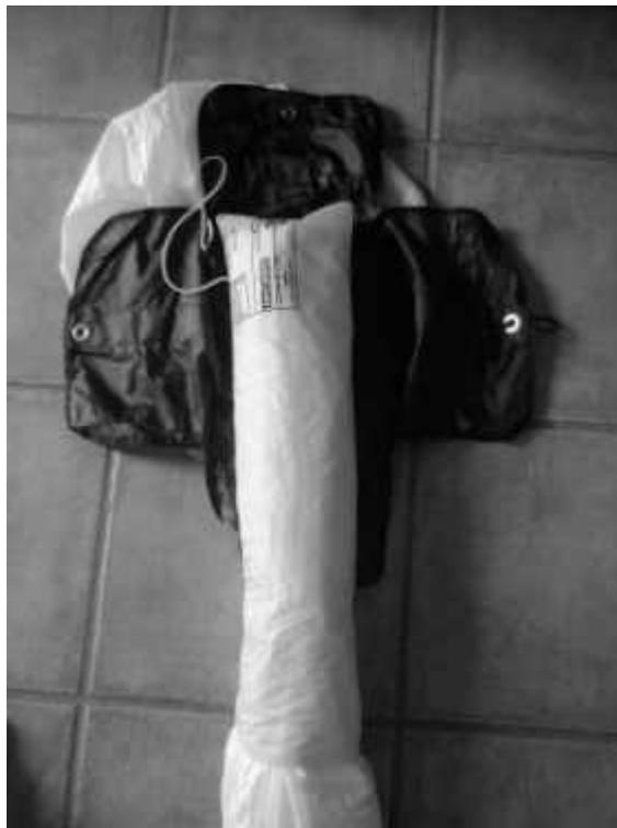
**Abbildung 10: Einlegen der Kappe in den Innencontainer**
