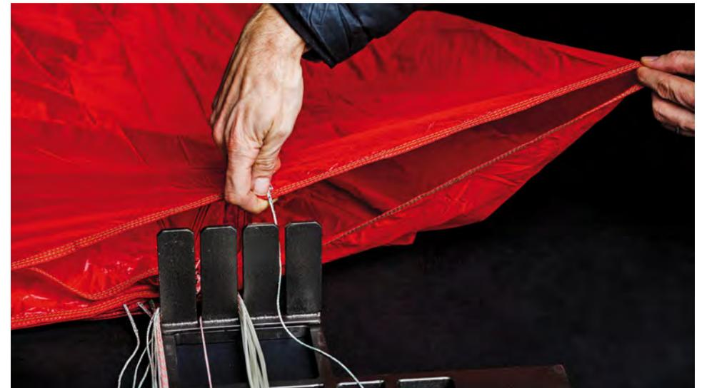
Falte Bahn für Bahn mit der grünen Naht an der Basis zur rechten Seite und lege dabei die grünen Fangleinen in den rechten Schlitz des Leinenhalters. Während du die Bahnen auslegst, achte darauf, dass diese ordentlich eine auf der anderen zum Liegen kommen und dabei eine gerade Basis bilden.
