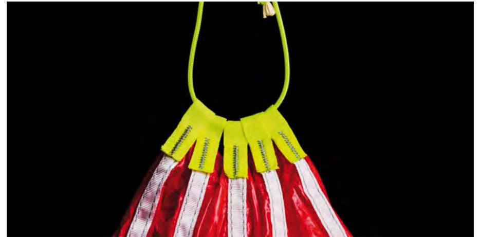
Führe die 5 gelben Packschlaufen mittels einer Packleine zusammen und sichere diese ebenfalls.
