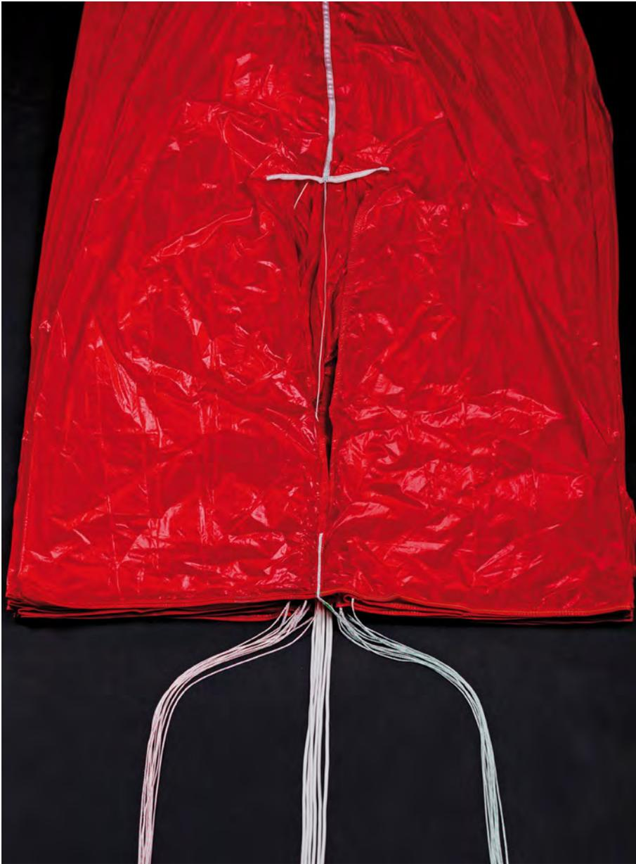
Lege die Kappe so aus, dass die Bahn mit dem Öffnungsschlitz ganz oben aufliegt.
