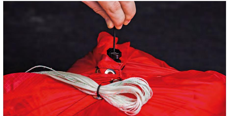
Der Anpressdruck der zentralen Verschluss-Gummischlaufe wird über den integrierten Loop-Spanner geregelt. Dieser wird so eingestellt, dass das Rettungsgerät durch anheben an der Verbindungsleine vom Innencontainer freigegeben wird. Der Loopspanner befindet sich unter dem 4. Containerblatt und damit lässt sich der Anpressdruck über die schwarze Gummikordel regulieren.
