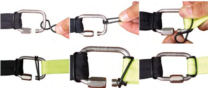
Das Verbindungsglied muss über eine Minimum-Bruchlast von mindestens 2400 daN verfügen und wird mit Gummiringen oder einem Neoprensenschutz gegen ein Verrutschen gesichert (**Achtung:** 50% Festigkeitsverlust bei einer Querbelastung).
