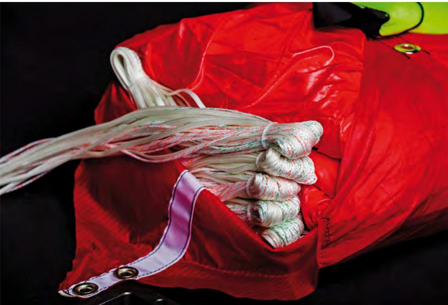
Verstau die Fangleinen zwischen der gefalteten Kappe und der Container Seitenwand.
