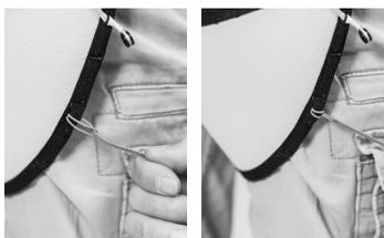
Passer le mousqueton dans le trou prévu à cette effet et dans la boucle de la drisse haute.
