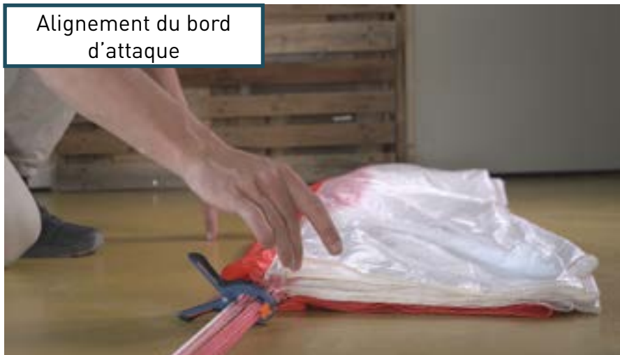
Mise à plat du premier panneau
