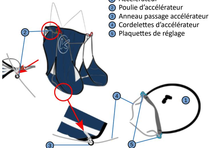
Le réglage de l'accélérateur se fait au niveau des plaquettes de réglage situées sur celui-ci.
