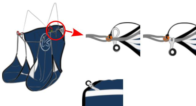
Pour installer l'accélérateur (en option), il suffit de faire passer la cordelette dans la poulie située sur le côté de la sellette, puis de l'insérer dans l'anneau situé à l'avant de la cuisse.
