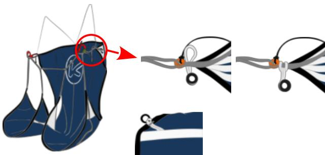
Stecke das Fußbeschleunigerseil je Seite dann einfach durch den Umlenkring und führe es anschließend durch den Ring an der Beinschlaufe.
