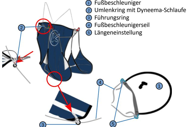
Der Fußbeschleuniger ist in der Länge verstellbar. Bei optimaler Einstellung kann der gesamte Geschwindigkeitsbereich des Schirms ausgenutzt werden, wenn die zweite Stufe mit gestreckten Beinen betätigt wird.
