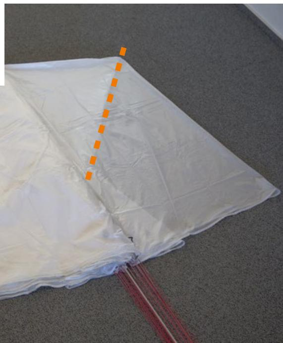
▶ Bahn 7 wird nun gelegt. Auch der obere Kappenrand sollte straff nach aussen gezogen werden dabei wird auf den diagonalen Verlauf der inneren Stofffaltung geachtet mit der Bahn 6 wird gleich verfahren
