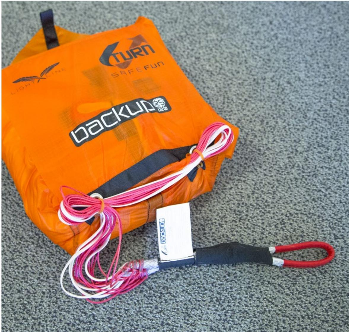
▲ Schutzdeckel verschließen und mit dem Leinenende durch die zwei Gummilassenschnäuren und fixieren. Die BACKUP RS ist nun bereit für den Einbau ins Gurtzeug oder den Außencontainer.
