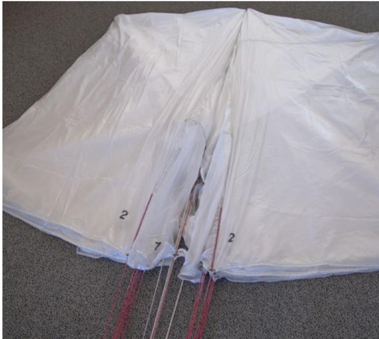
◀ Die Kappe ist nun so angeordnet dass in der Mitte die Bahn 1 links und rechts die Bahn 2 zu sehen sind
