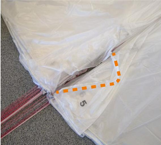
◀ Die kleinere Eckbahn (5) entsprechend der Abbildung rausziehen und die Öffnung sauber legen
