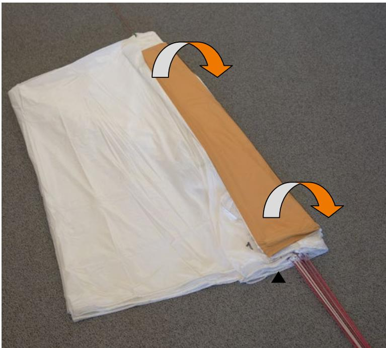
▲ Um die linke Seite auch in einem S-Schlag zu legen wird der fertige S-Schlag um die Mittelachse nach unten gewendet. Siehe dazu die Schematische Darstellung 1-3 Die Mithilfe einer zweiten Person vereinfacht diesen Arbeitsschritt wesentlich, da so die bereits im S gelegte Bahn während der Drehung oben und unten fixiert werden kann
