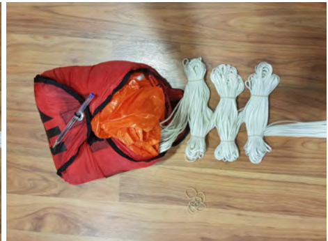
ÉTAPE 20 : mettre en place les élastiques pour maintenir les suspentes correctement lovées.
