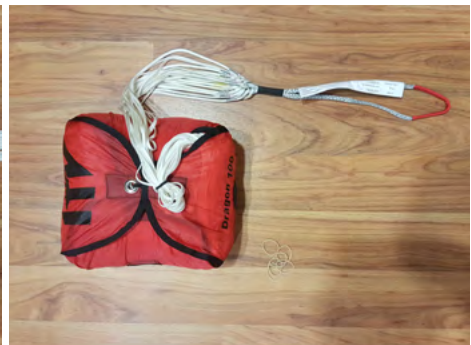
ÉTAPE 22 : Fermé le POD grâce au suspentes. largeur de la boucle = 3 doigts
