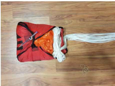
ÉTAPE 21 : Ranger les suspentes dans le POD à l'avant de la voilure en gardant 1.20 m de suspentes pour le lovage extérieur.
