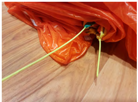
ÉTAPE 16 : Enlever la drisse de maintien des gâchettes.
