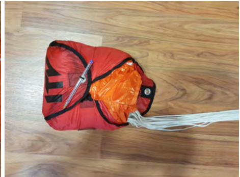
ÉTAPE 18 : mettre en place les rabats du conteneur pour former un paquet propre et compact, en gardant bien en forme le bord d'attaque du parachute replié. Utiliser une aide temporaire (stylo) afin de garder les 3 premiers rabats du conteneur en place.
