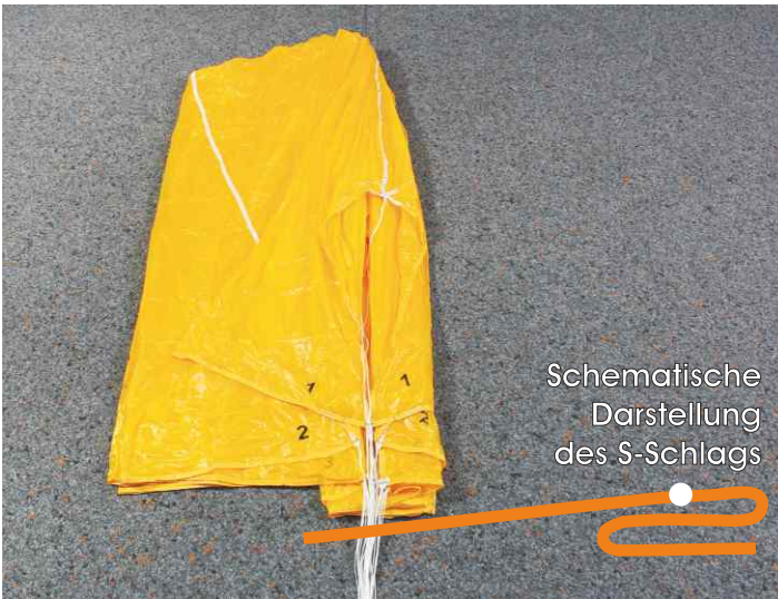
21. Rechte Seite S-förmig einschlagen (Schritt 1).
