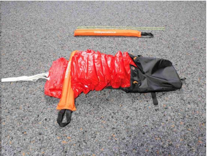
10. Oberes Kappenende in den Innencontainer einlegen und restliche Kappe in kleinen S-Schlägen vor den Innencontainer legen.
