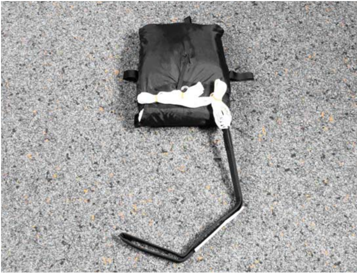
13. Innencontainer mit den Fangleinen verschließen. Zuerst die Mitte, dann Außen.
