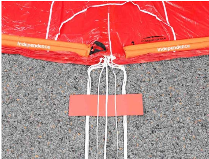
7. Fangleinen 1 und 16 und Mittelleinen auf kreuzungsfreien Verlauf kontrollieren.
