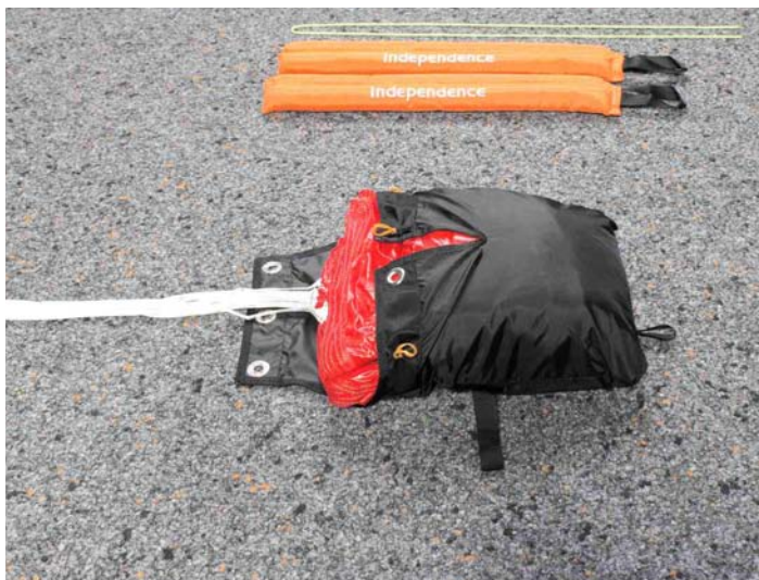
11. S-Schläge in den Innencontainer einlegen.
