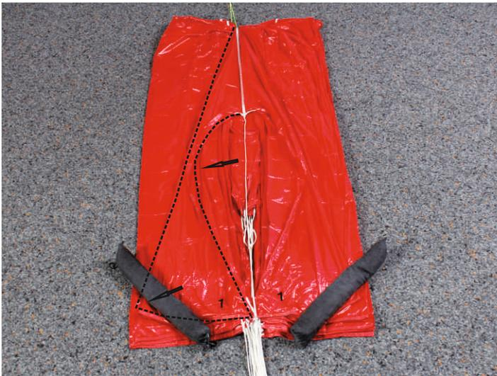
15. Bahn 1 legen. (Eckbahn) und Basis mit Gewicht beschweren.
