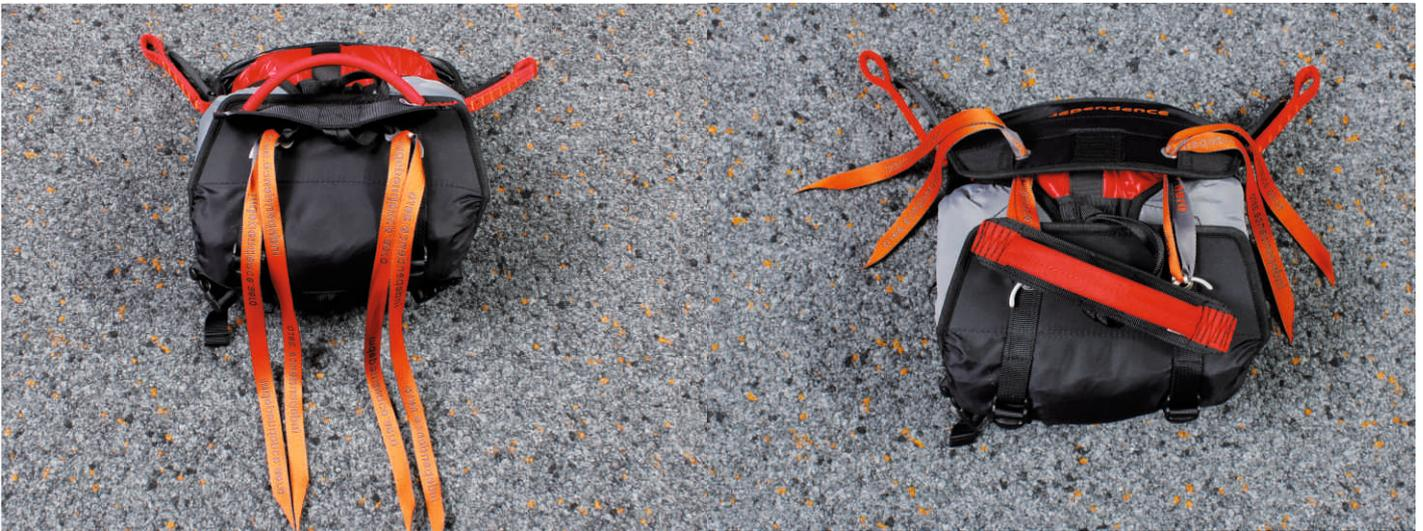
6. Untere Verschlussklappe schließen und mit den Splinten des Auslösegriffes provisorisch sichern.
