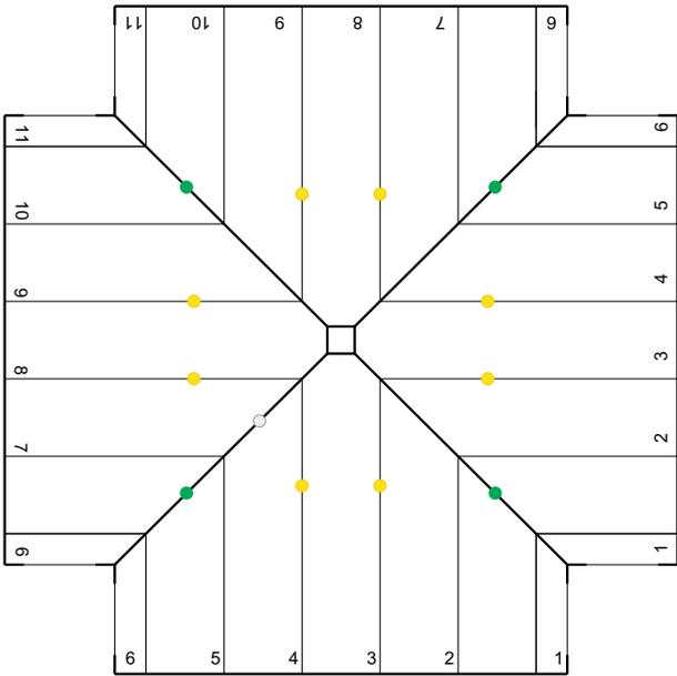
**Cornetto 100:** Zum leichteren Auffinden sind die Packschlaufen farblich markiert. Der Cornetto 100 besitzt 4 grüne Eckpackschlaufen, 8 gelbe Packschlaufen an den Längsseiten sowie eine weiße Packschleufe nahe dem Scheitel.
