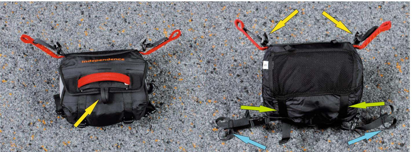
8. Obere Verschlussklappe schließen und mit den Splinten des Auslösegriffes sichern. Griff unter die Griffabdeckung stecken und Packschnüre entfernen. Darauf achten, dass die Griff-Innencontainerverbindung (Pfeil) genügend lang ist, damit bei der Auslösung die Splinte freigegeben werden. Die Packung, ggf. Kompatibilitätsprüfung im Packnachweisheft vermerken!
