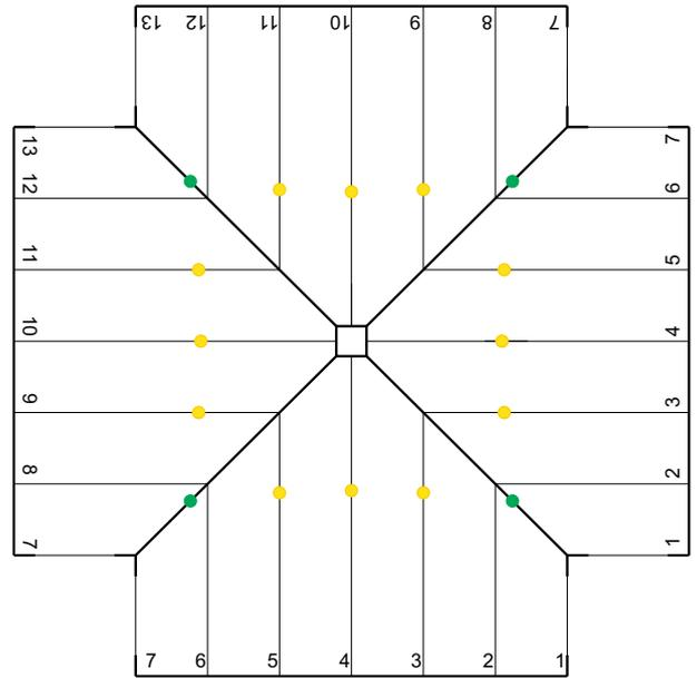
**Cornetto 140:** Zum leichteren Auffinden sind die Packschlaufen farblich markiert. Der Cornetto 140 besitzt 4 grüne Eckpackschlaufen und 12 gelbe Packschlaufen an der Längsseite.
