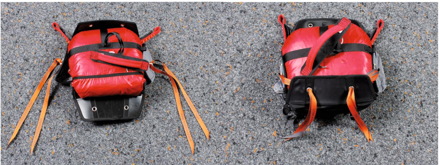
4. Je eine Packschnur rechts und links in die Schlaufen einfädeln.
