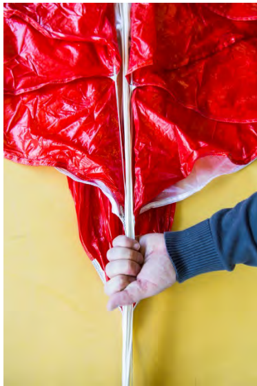
Fig. 87 Toutes les suspentes doivent bien être au centre de la voile
