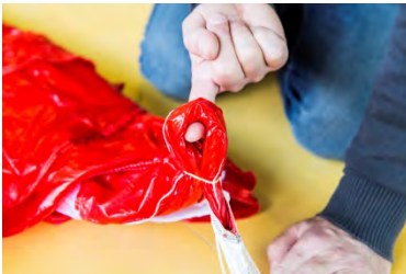
Fig. 112-115 Sécurisez l'ensemble au bord de fuite avec un élastique
