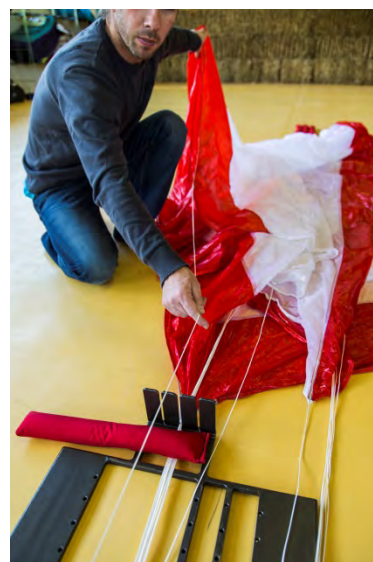
Fig. 55 Mettez cette suspente dans le séparateur (poids)
