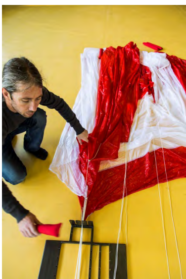
Fig. 71 Suspente #4 dans le séparateur
