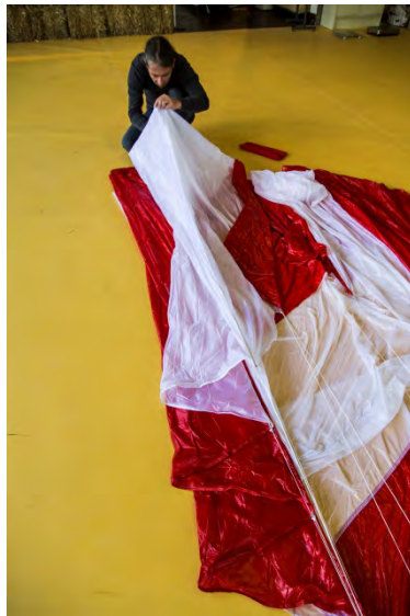
Fig. 75-77 Pliez les panneaux restants jusqu'au nez...
