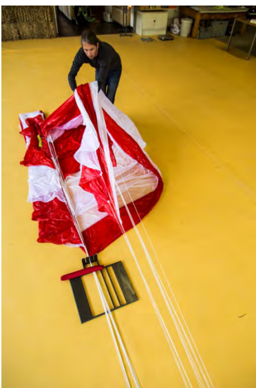
Fig. 80-82 Retournez la deuxième partie du parachute par-dessus le séparateur sur la partie déjà pliée
