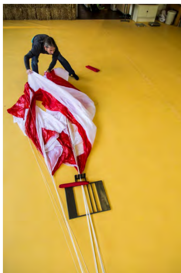
Fig. 80-82 Retournez la deuxième partie du parachute par-dessus le séparateur sur la partie déjà pliée
