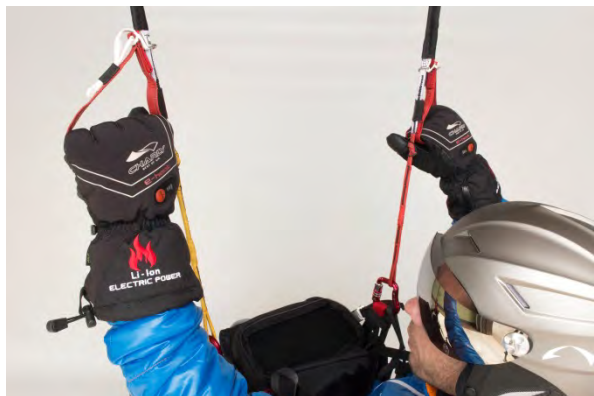
Fig. 1 Attache aux maillons principaux (pos. ventrale)
