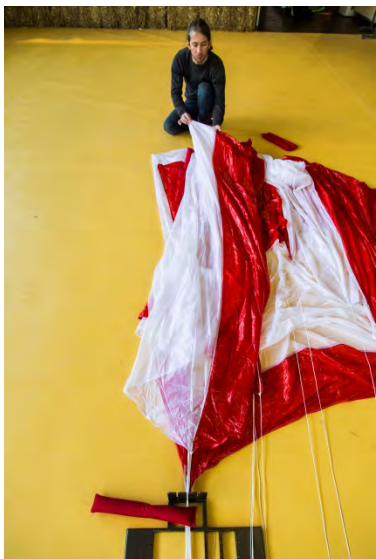
Fig. 68 Suspente du panneau #3 dans le séparateur
