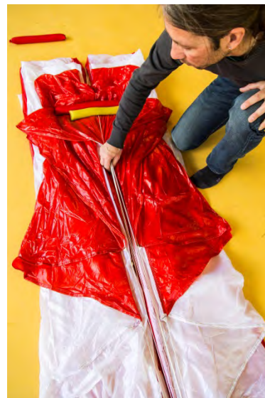
Fig. 85 Vérifiez que les suspentes soient bien claires ...
