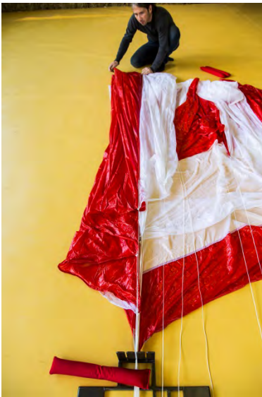
Fig. 74 Suspente dans le séparateur
