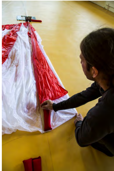
Fig. 57 Couture sur la suspente centrale
