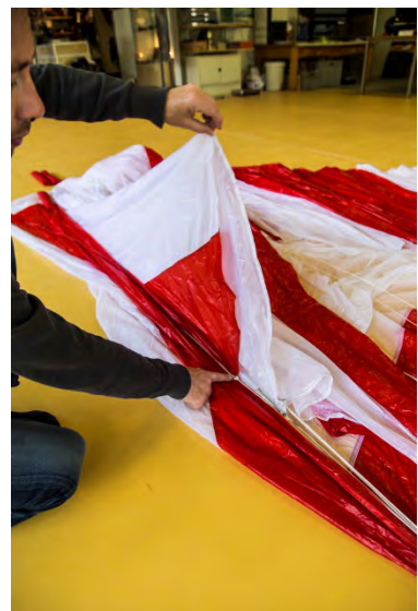
Fig. 64 Placez le point d'ancrage sur la suspente central et tenez le
