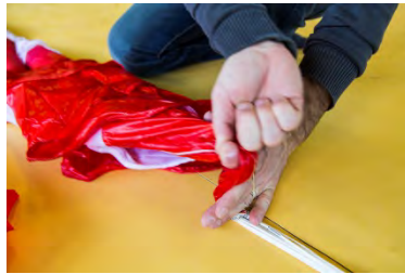
Fig. 112-115 Sécurisez l'ensemble au bord de fuite avec un élastique
