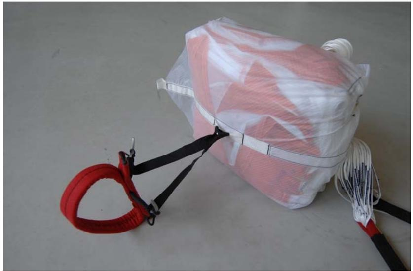
Fig. 112 Attache de la poignée pour une utilisation en container ventral
