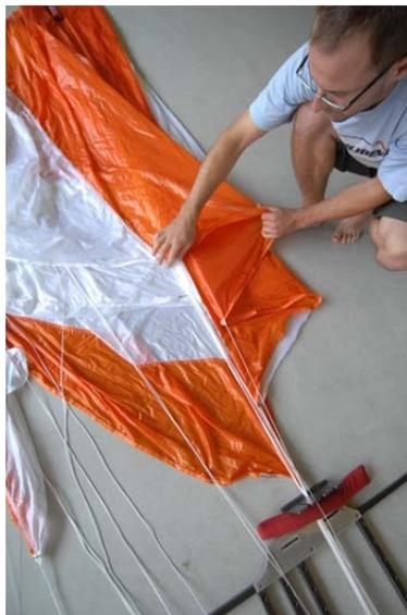
Fig. 51-52 le pliage des panneaux suivants jusqu'au bout d'aile suit la procédure décrite pour les panneaux 3, 4 and 5
