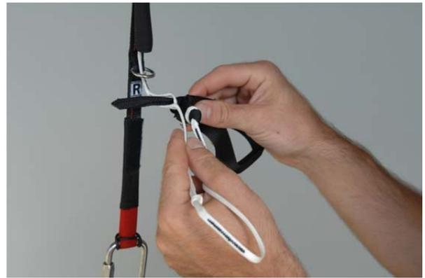
Fig. 4 Positionnement de la suspenne de frein pour une ouverture freins tirés. (attache aux épaules)
