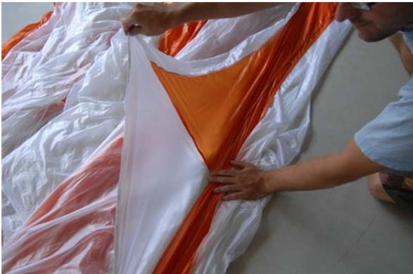
*Fig. 36* Mettez la suspente avec son point d'ancrage du panneau n°2 au-dessus des suspentes centrales et maintenez les avec votre main
