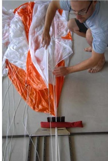
*Fig. 39-40* Placez les suspentes du panneau N°3 dans le séparateur et mettez le au dessus des suspentes centrales.
