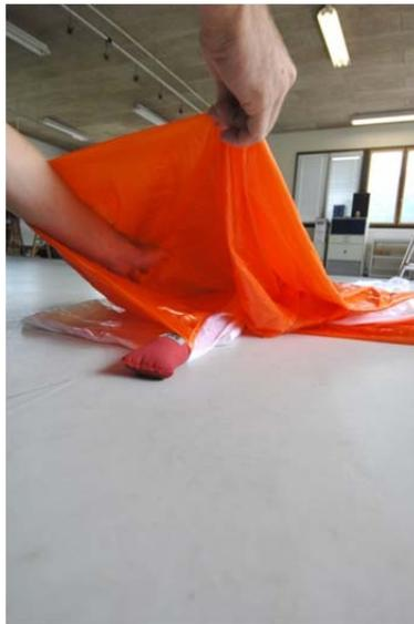
Fig. 48-49 Balayez le panneau 4 vers l'extérieur (pliage en S)
