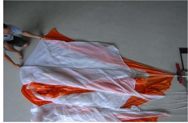
*Fig. 33* Ecartez le panneau n°1. Attention: vérifiez bien que la suspente soit au-dessus des suspentes centrales. La taille et la forme de ce panneau peu varié en fonction de la configuration des demi-freins.
