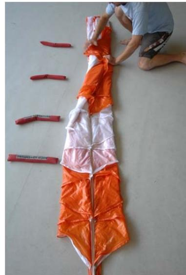
Fig. 79 Placez les deux côtés l'un sur l'autre
