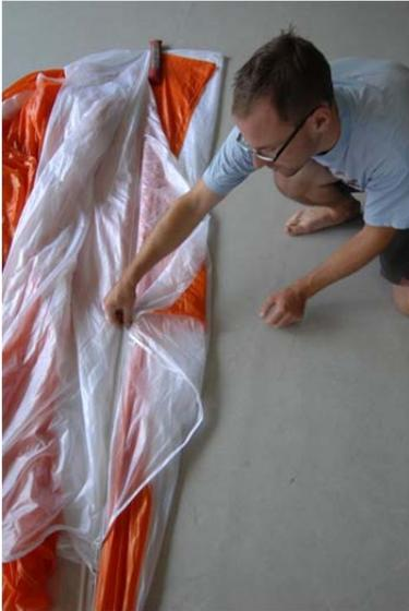
*Fig. 38* Réduisez le panneau N°2 par un pliage en S
