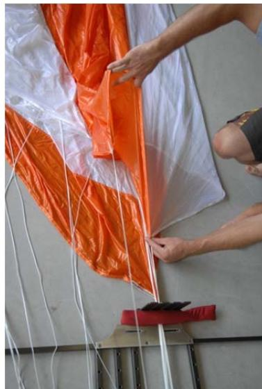
*Fig. 45-46* Placez les suspentes du panneau N°4 dans le séparateur
