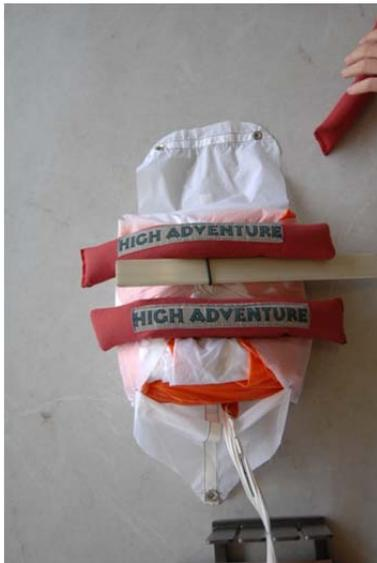
Fig. 97 Maintenez le pod avec un poids suffisant
