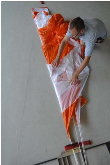
Fig. 65 Les suspentes centrales forment l'axe de symétrie
