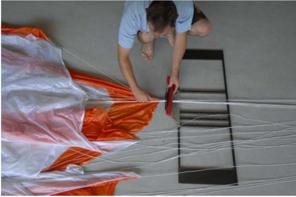
*Fig. 32* Placez la suspente du panneau n°1 dans le séparateur.
