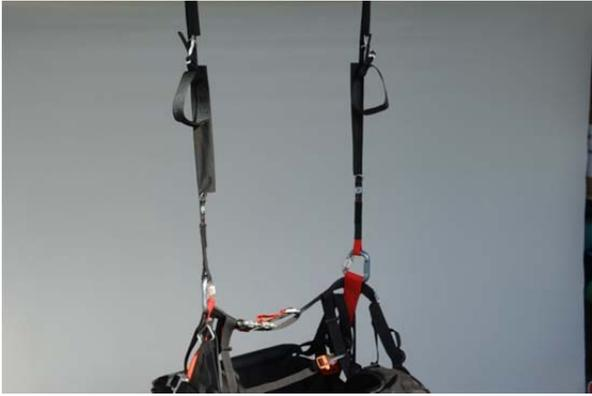
Fig. 1 Attache aux maillons principaux (pos. ventrale)
