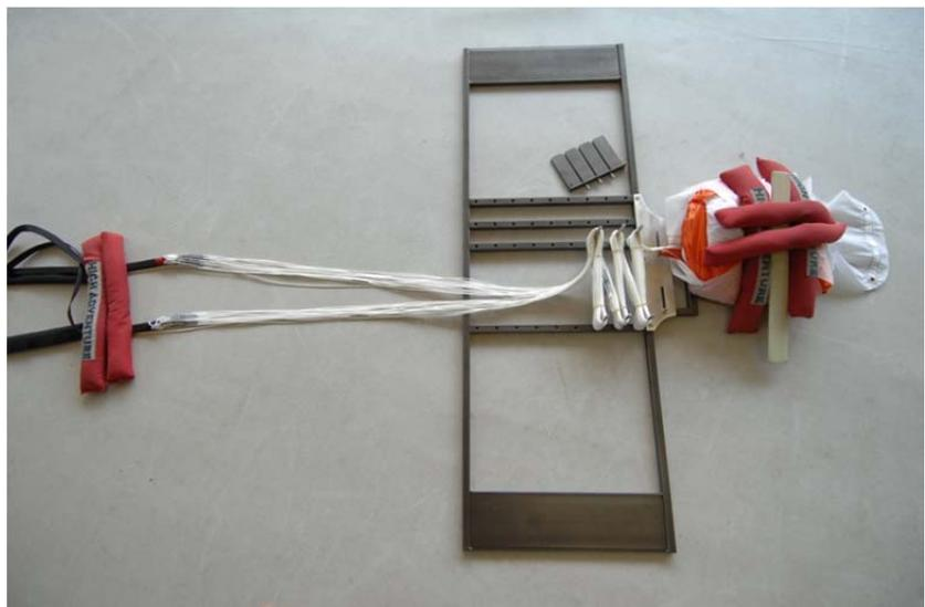
Fig. 101 Les derniers 50-60cm de suspentes sont utilisés pour fermer le pod et ne doivent pas être pliés.
