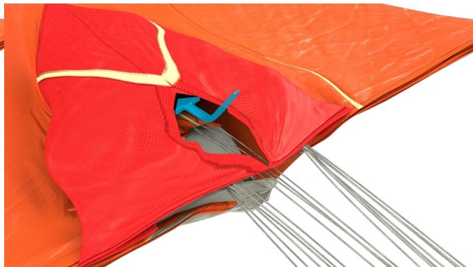
Figure 14 – Apex repliée au milieu des suspentes centrales.
