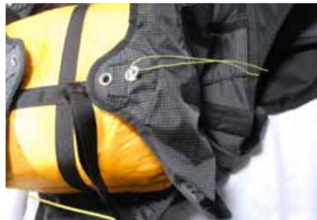
Enfiler une drisse dans la boucle du cordon élastique de droite (si poignée à droite).
