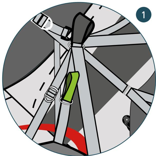
1 Repérer le point d'attache vert à gauche il doit passer dans l'anneau métallique.
