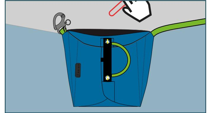
11 Une fois attaché dans la sellette, fermer le clip du cocon puis connecter le Whichard au point d'attache parachute côté droit.
