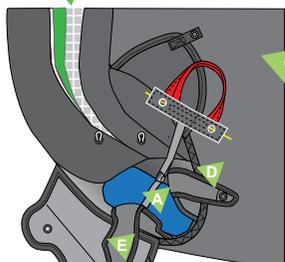
**1** Rentrer le parachute de secours dans la poche de la sellette en laissant dépasser les volets extensibles D et E. La poignée doit être orientée vers le haut
