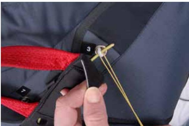
Faire passer la drisse et le cordon élastique dans l'oeillet N°3 et passer le jonc de la poignée dans l'anneau élastique. Puis le bout du jonc et le bout de la poignée derrière la partie néoprène du rabat N°3
