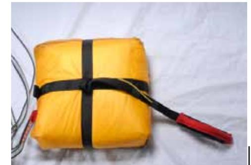
La poignée doit être connectée à la boucle centrale.
