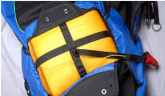
Rentrer le parachute de secours dans la poche de la sellette en ouvrant tous les volets. Le POD doit être orienté avec la poignée vers le haut et les suspentes et élévateurs en bas.
