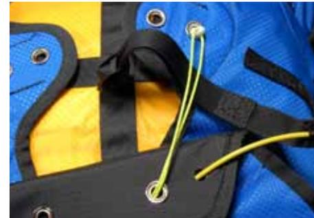
Faire passer le cordon élastique dans l'œillet du volet bas. On passe également le câble jaune dans le passage du volet inférieur.
