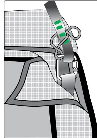
4. Répéter 1, 2 et 3 avec un autre joint torique pour l'attache côté sellette. Serrez correctement la écrou du Maillon Rapide®, au besoin avec une pince.
