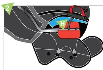
2. Bien placer les élévateurs du parachute (I) restant à l'extérieur du P.O.D (H) à l'intérieur de la poche parachute.
