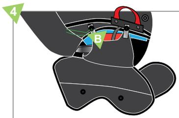
4- A l'aide d'une drisse, faire passer la cordelette C dans l'oeillet gauche du volet souple (B)
