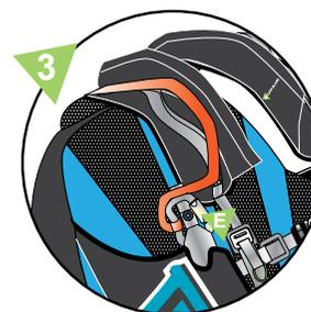
1. Placer le pod de façon correcte (logo «this side up» avec flèche vers le haut). Faire sortir la sangle de connexion du pod et la placer au dessus des éleveurs de connexion voile de BASE. Vérifier qu'il n'y a aucun twist et que la sangle de tourne pas autour de ces éleveurs.
