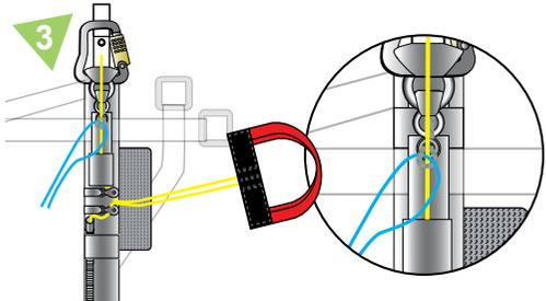
Étape 3 : A l'aide de la drisse de pliage, faire passer la drisse plate blanche dans la sangle avec œillet puis faire rentrer les câbles dans la boucle ainsi formée. Retirer la drisse lentement afin de ne pas endommager la drisse plate.
