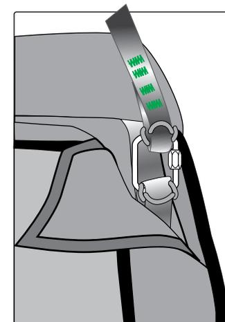
5. Ranger le surplus d'élévateurs proprement sous les rabats.
