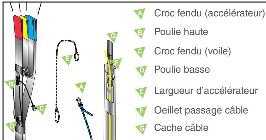
1. Retirer le croc fendu et enlever la drisse d'accélérateur des poulies. Ranger cette drisse à l'aide d'un (velcro?, scotch?) afin qu'elle n'interfère pas avec le système.
