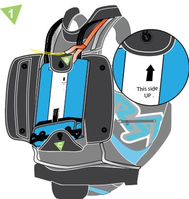
1. Mettre en place le pod en veillant à bien respecter le sens (marquage «this side up») ainsi que l'absence de twist de la sangle de connexion. Rabattre les volets supérieurs et inférieurs.
