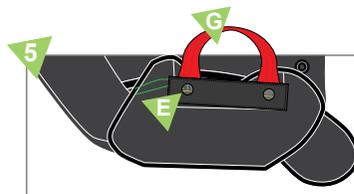
5. A l'aide de la drisse faire passer la cordelette dans l'oeillet gauche du volet inférieur (E) puis dans le câble de la poignée (G). Retirer la drisse doucement.
