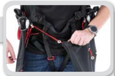
Das Cockpit ist am oberen Ende des Pods mit einem Reißverschluss verbunden. In der Luft befindet es sich über dem Brustgurt. Das mitgelieferte elastische Band kann optional benutzt werden. Du kannst es um deinen Hals hängen wodurch das Cockpit beim Starten eine gute Position behält.
