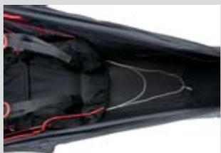
Die Leinen der Speedbar müssen gleich lang und sollten nicht zu kurz sein um nicht versehentlich das Speed System zu aktivieren, wenn es in der Luft unter Spannung gerät. Überprüfe die Längen und die Symmetrie immer doppelt am Boden ehe du fliegst.
