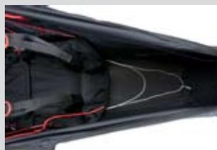
Vérifiez que les cordons de l'accélérateur soient de la même longueur. Vérifiez aussi que les cordons ne soient pas trop courts car cela pourrait entraîner une activation de l'accélérateur quand ce dernier est sous tension en l'air. Revérifiez ceci au sol avant le décollage.
