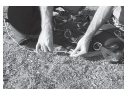
Stelle sicher, dass die Leinen der Speedbar gleich lang sind, und vergewissere dich gründlich, dass sie auch nicht zu kurz sind, da dies den Beschleuniger unbeabsichtigt aktivieren könnte, wenn die Leinen in der Luft unter Spannung geraten.
