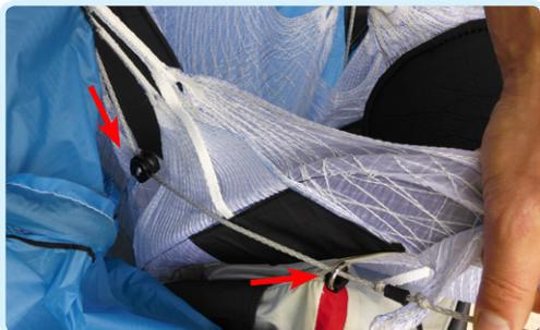
La ligne passe ensuite dans la poulie Ronstan puis l'anneau en évitant que la fixation de la poulie ne soit torsadée. Veillez à ce que la ligne passe proprement et entièrement du côté intérieur de toutes les sangles structurelles. Revérifier très attentivement qu'aucune ligne ne passe autour des sangles structurelles avant de les attacher au barreau. Enfin, le barreau peut être connecté à l'élastique qui est attaché à la planche repose-pieds.
