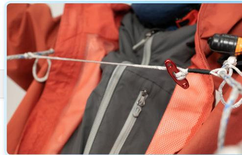
Le système de fermeture du cocon peut maintenant être connecté. En premier c'est le connecteur mâle du côté gauche du cocon qui doit être connectée au connecteur femelle situé sur la structure du côté droit (repères bleus). Ensuite, faire passer le connecteur mâle de l'anti-oubli rouge dans la boucle rouge située sur le conteneur de parachute avant de la connecter au connecteur femelle rouge attaché au côté gauche du cocon.
