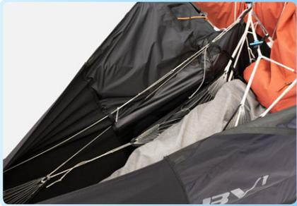
De petits ajustements de l'assiette et de la longueur du cocon peuvent aussi être réalisés avec un réglage par épissures coulissantes. On peut modifier l'angle du repose-pieds en changeant les longueurs relatives du haut et du bas.
