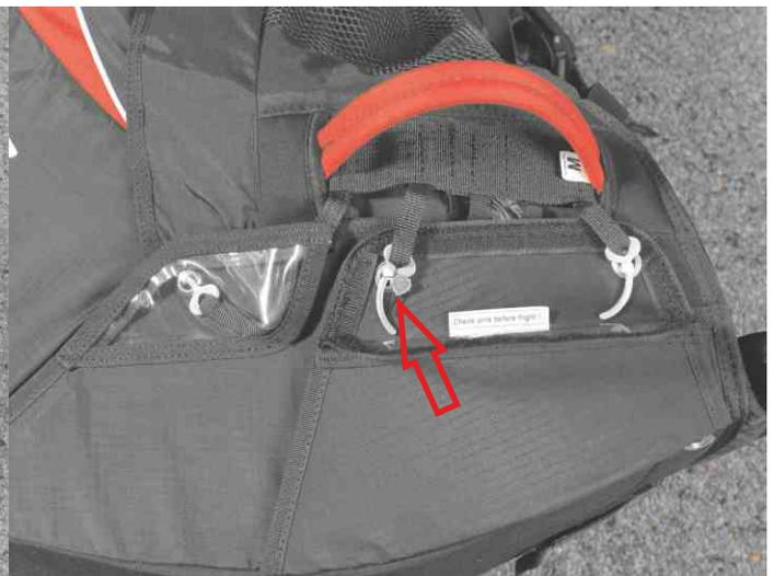
6. Alle Packschnüre entfernen! Mittleren Splint mit Sollbruchfaden sichern und Abdeckungen schließen.
