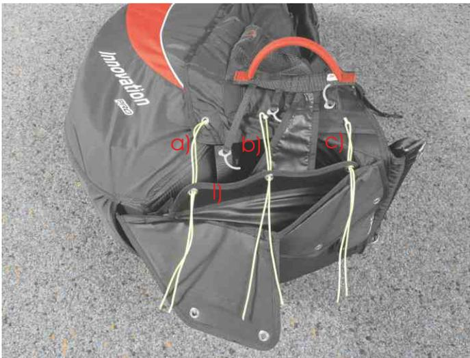
3. Container mit Hilfe von Packschnüren (a,b,c) schließen. Die Verbindung Griff-Container wird zwischen b) und c) gelegt. Dann die 3 Packschnüre durch die Ösen des Spannbandes (I) führen.
