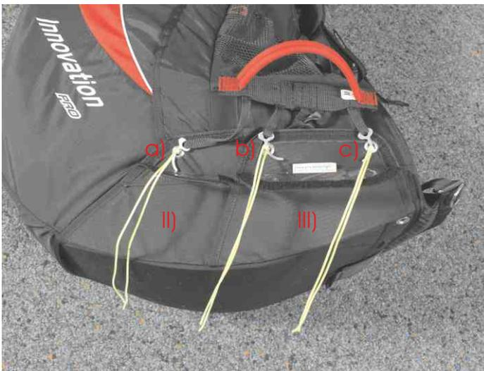
5. Die vordere Containerklappe (III) mit Packschnur b) und c) schließen und mit den Splinten sichern.
