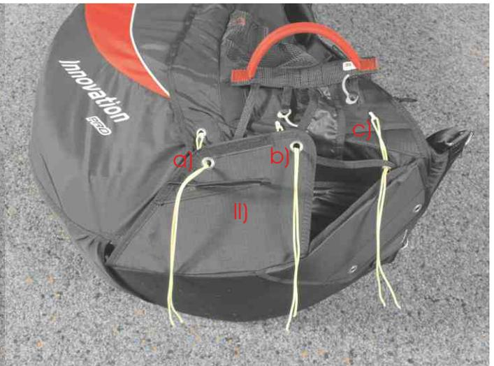
4. Die hintere Containerklappe (II) mit den Packschnüren a) und b) schließen.
