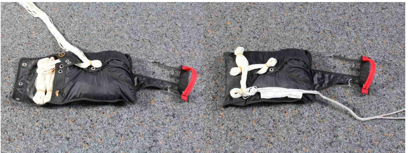
4. Container mit den Fangleinen verschließen. Zuerst wird der rechte Containerflügel mit dem oberen und unteren verschlossen. Je nach Größe des Rettungsfallschirmes können die äußeren oder inneren Ösen zum Verschließen verwendet werden.
