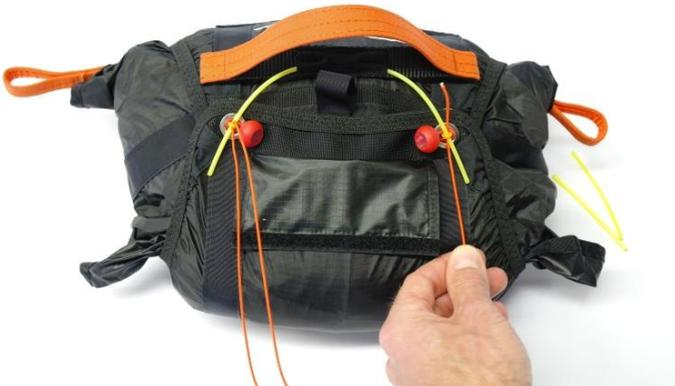
Les extrémités des goupilles doivent être placées dans les petites poches prévues sur le volet #3
