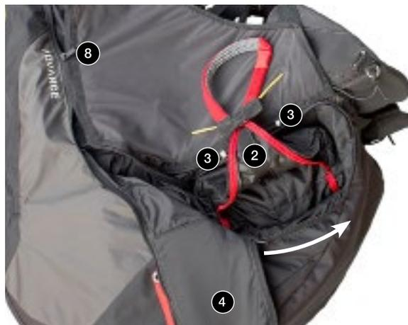
**!** **Attention :** si, après un repliage, le parachute de secours ne tient plus dans le conteneur interne, tu dois le replier correctement pour qu'il épouse parfaitement la forme du conteneur interne.
