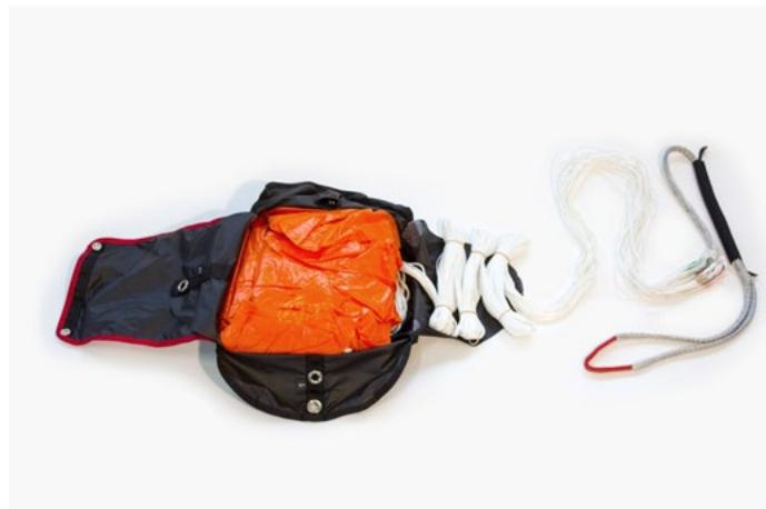
Ferme les rabats du conteneur dans l'ordre indiqué (1-3). Fixe le dernier rabat du conteneur avec une boucle de suspentes de 5 à 6 cm (environ trois largeurs de doigts). Puis vérifie la tension de la boucle élastique et ajuste-la si nécessaire. En soulevant le paquet par les suspentes le poids du secours doit libérer la boucle des suspentes.
