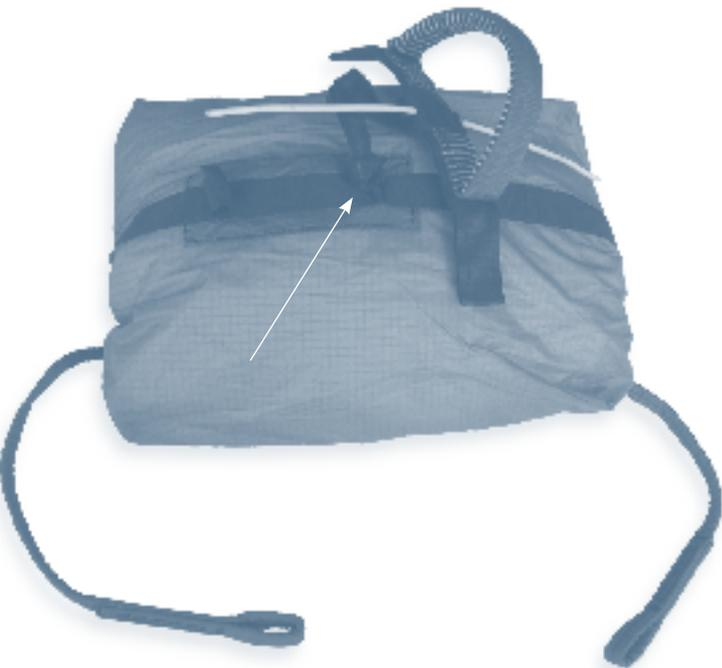
mousqueton ne glisse, créant une traction latérale lors de l'ouverture du parachute de secours.
