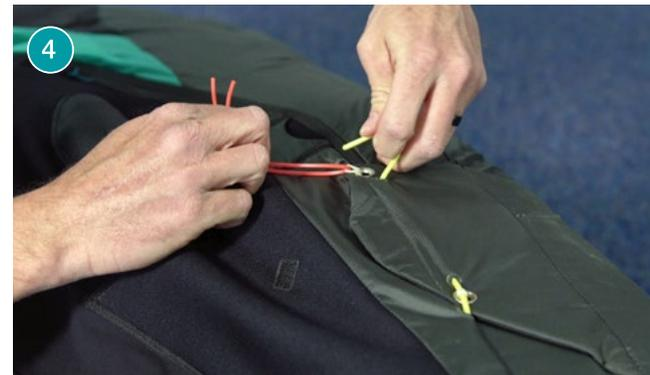
Sécurise l'oeilleton et sa boucle avec une suspente d'aide ou avec la tige de pliage rouge en V.
