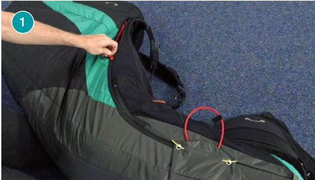
Ferme la fermeture éclair et tire-la depuis le compartiment du secours gauche jusqu'en haut de la selle...
