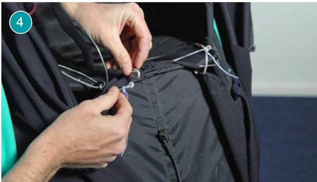
Fais un noeud d'ancrage dans la partie inférieure marquée en rouge de la cordelette et fixe-la à la cordelette rouge sur le repose-pied.
