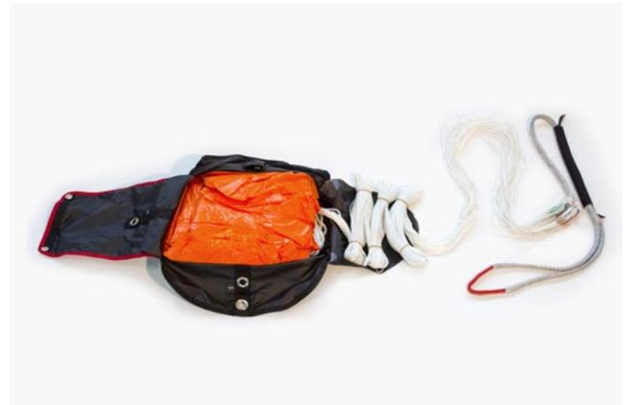
Ferme les rabats du conteneur dans l'ordre indiqué (1-3). Fixe le dernier rabat du conteneur avec une boucle de suspentes de 5 à 6 cm (environ trois largeurs de doigts). Puis vérifie la tension de la boucle élastique et ajuste-la si nécessaire. En soulevant le paquet par les suspentes le poids du secours doit libérer la boucle des suspentes.
