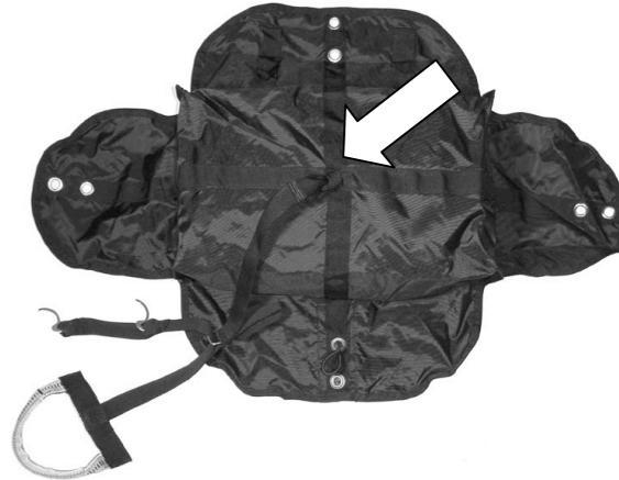
*Es in jedem Fall ist sicherzustellen, dass die Öffnungskraft für das Rettungssystem 70 N nicht überschreitet. Wir empfehlen, einen der beiden Splinte mittels eines Bindfadens mit definierten Reisskraft zu sichern. Die zu überwindende Sollbruchstelle soll 50 N betragen.*
