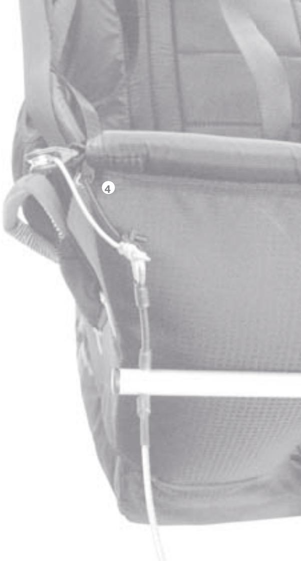
Das AXESS 2 AIR verfügt über einen Rückholer für die Beschleunigerstange. Dieser garantiert, dass der unbenutzte Beschleuniger eng an der Sitzbrettkante anliegt und eine Rettungsschirm-Auslösung nicht behindert. Der fix eingenähte Elastik-Rückholer wird durch den Plastikring an der Sitzbrett-Vorderkante (4) durchgezogen und – nicht unter Zug stehend – an der Beschleunigerstange so kurz wie möglich befestigt.
