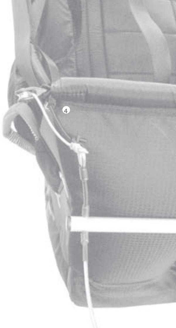
L'AXESS 2 AIR dispose d'un élastique de rappel de la barre d'accélérateur. Celui-ci assure que la barre soit maintenue au plus près du bord de la planche lorsqu'elle n'est pas utilisée afin de ne pas entraver l'ouverture du parachute de secours. L'élastique, fixé par une couture, doit passer dans l'anneau en plastique au bord de la planche (4) puis être fixé, le plus court possible et sans être tendu, à la barre de l'accélérateur.
