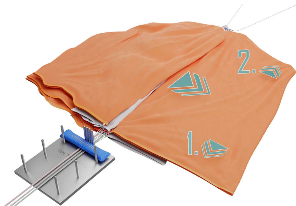
Fig. 28 Obtenir un bord inférieur bien droit.
