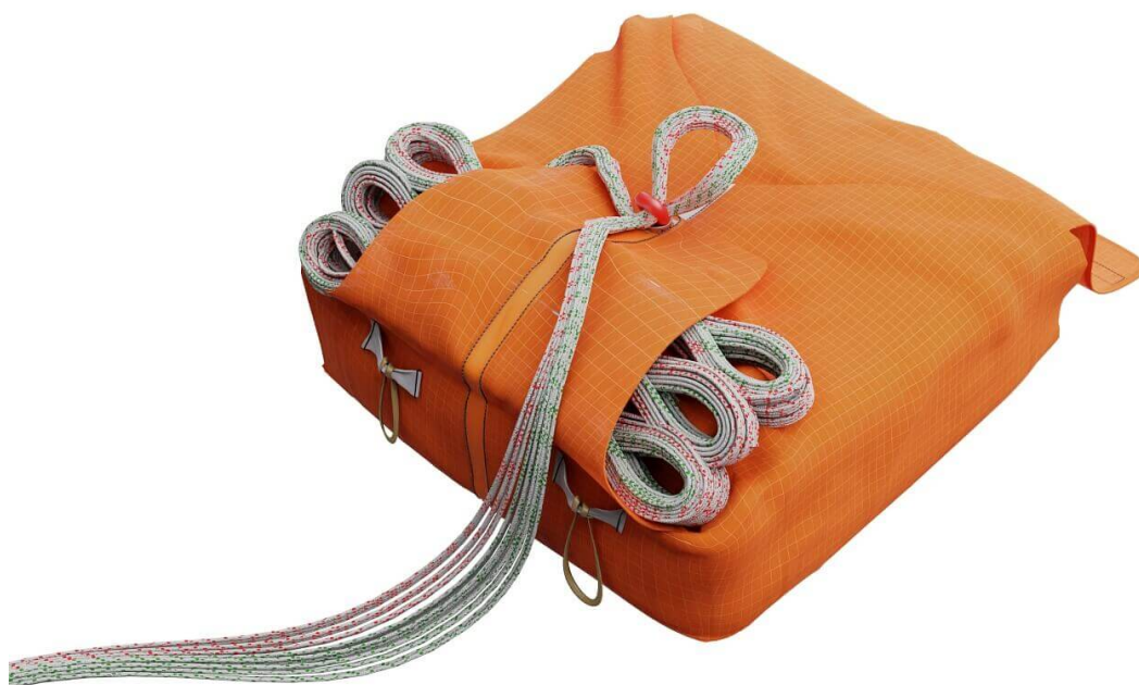
Fig. 45 Fermeture du conteneur SQR.
