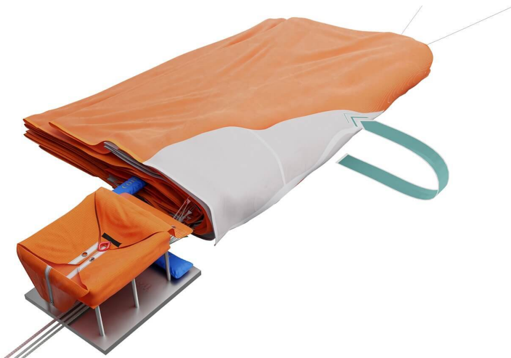
Fig. 34 La moitié inférieure (droite) est repliée,
