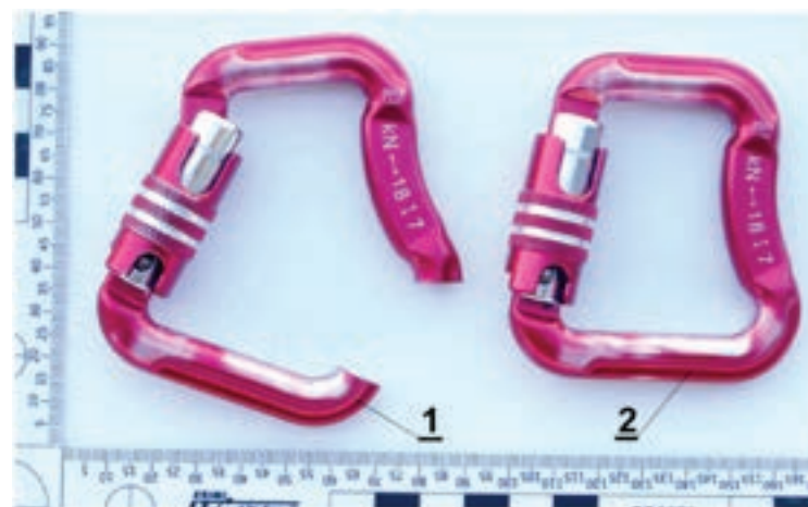
EXEMPLE DE RUPTURE DE MOUSQUETON EN ZICRAL EN VOL (MODÈLE INTERDIT DE VOL : VOIR [3,4])
