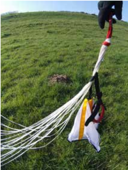
Poignée longue : un risque de s'enrouler autour du faisceau de suspente lors de du lancer du pod.
