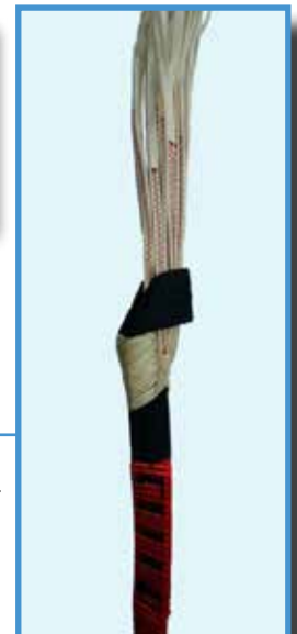
Liaison suspente et élévateur - sangle/suspente
